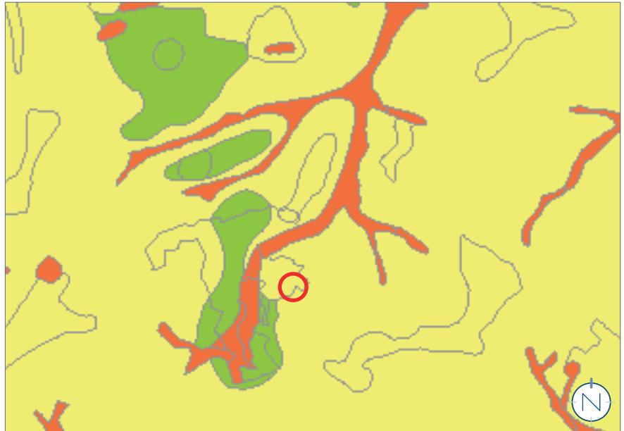
Versickerungsfähigkeit des Bodens (grün = geeignet, gelb = bedingt geeignet, rot = ungeeignet); Quelle: LVGL, GeoPortal Saarland; Stand der Abfrage: 16.01.2020
